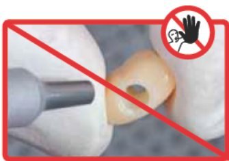
Do not blast IPS e.max Press object
